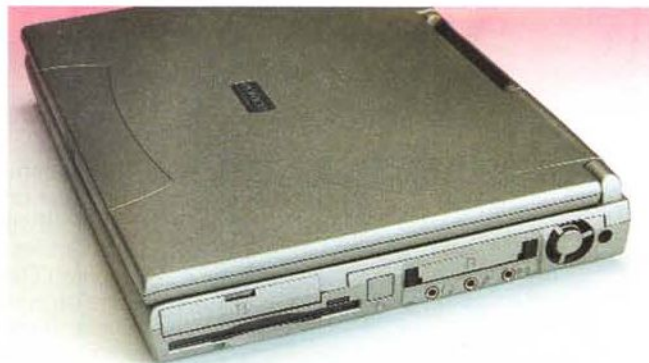
Alta ingegnerizzazione d'assemblaggio per la realizzazione di un apparecchio veramente all-in-one: sul lato destro della macchina, oltre al floppy drive integrato ed agli slot PCMCIA, sono posizionati il vano dell'hard disk estraibile, gli ingressi e uscite audio, la presa d'aria per la ventolina di raffreddamento e l'ingresso per l'alimentazione da rete elettrica. È visibile il coperchio di una presa RJ11 soltanto teorica: l'installazione di un modem interno non è prevista in questo modello.
